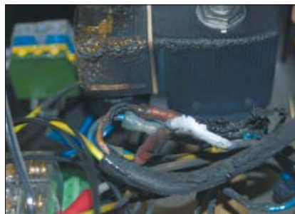
Brand durch Verwendung von Fremdkartuschen
