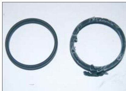
Ventildichtung. Gequollen und porös durch Verwendung von Fremdkartuschen
