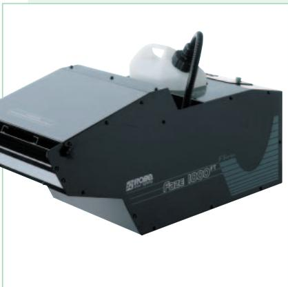
Der Hazer ROBE FAZE 1000 FT bietet einen innovativen Hochleistungsheizer für einen geringen Verbrauch von weniger als einem Liter Fluid für zwei Stunden Dauernebel bei 30%igem Ausstoß. Ausgestattet ist die Maschine im PCB-Design mit Aluminiumguss-Heizblock, einer leisen Pumpe und steuerbaren Doppelventilatoren, die in Verbindung mit dem DMX FOG CONTROL-Modul für eine hohe Ausstoßpräzision sorgen.
